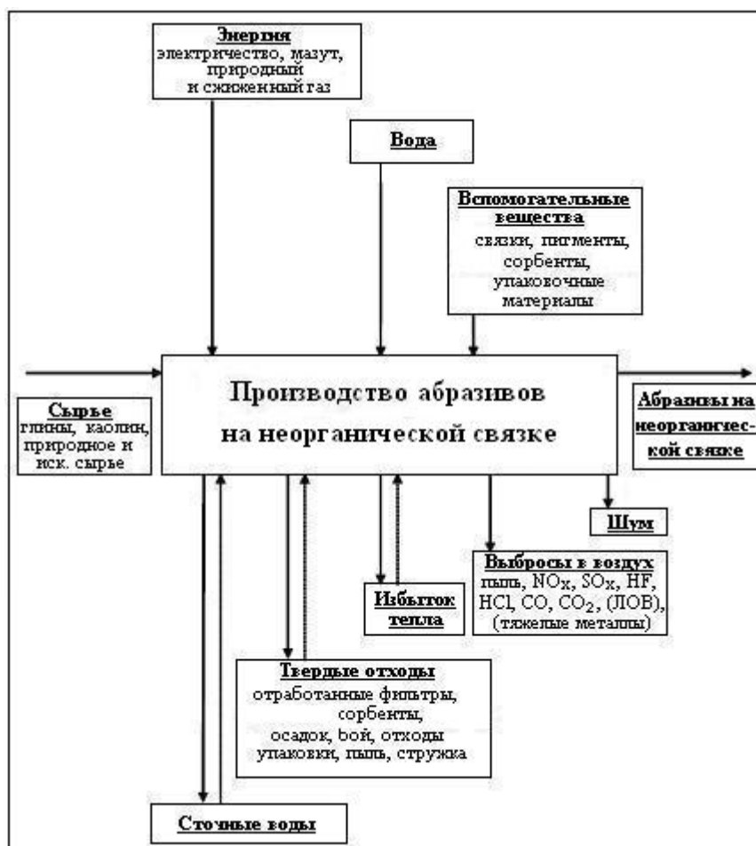
РИС. 2.30. ВХОДНЫЕ И ВЫХОДНЫЕ ПОТОКИ В ПРОИЗВОДСТВЕ АБРАЗИВОВ НА НЕОРГАНИЧЕСКОЙ СВЯЗКЕ
