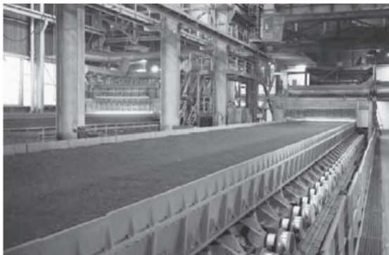
Рис. 3.1 Агломерационная лента с системой загрузки (барабаны или желоба) и горном зажигания [200]
