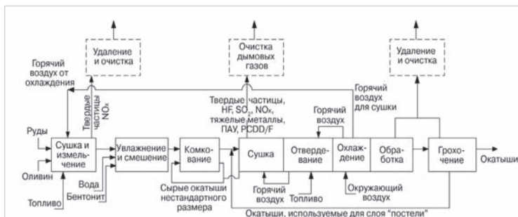
Рисунок 4.2: Схема установки для получения окатышей в Нидерландах. Источник: [200]
