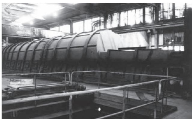
Рис. 3.21: Агломерационная лента с укрытием в соответствии с процессом EOS (выбросы при оптимизированном сжигании)
