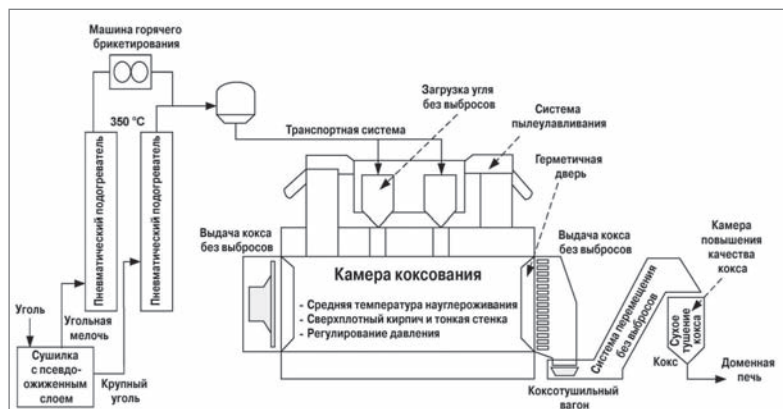
Рисунок 11.2: Технологическая схема производства кокса повышенного качества в процессе SCOPE 21 [320], [343]
