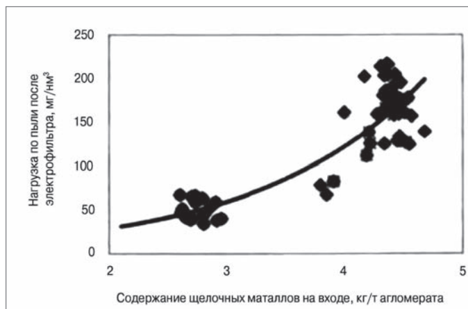
Рис. 3.13 Влияние содержания щелочных металлов на входе в процессе спекания на выбросы пыли после электростатического пылеуловителя (ESP) на агломерационной установке Voestalpine Stahl GmbH, Донавиц, Австрия
