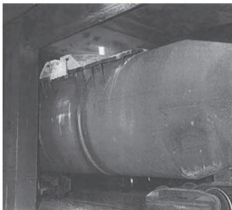
Рисунок 6.16: Заливка чугуна в ковш сигарообразной формы с подавлением образования пыли за счет продувки инертным газом [52]
