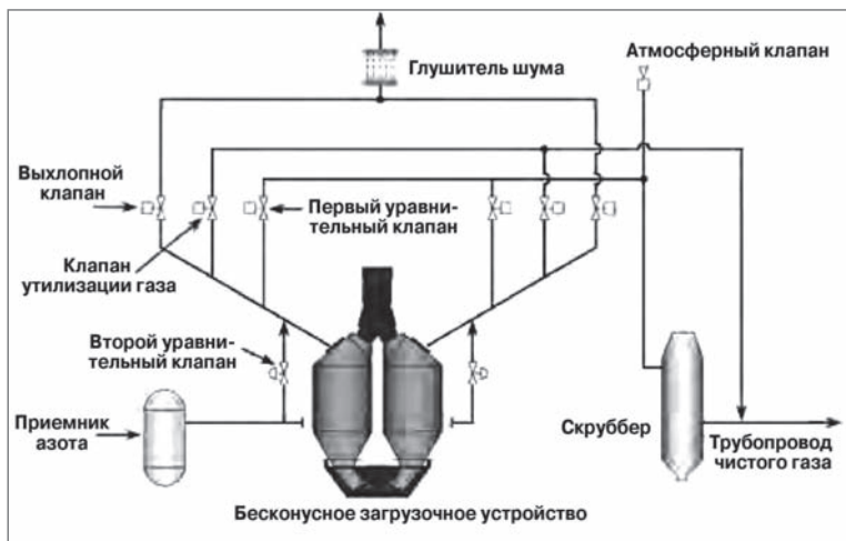
Рисунок 6.19: Схема бесконусного загрузочного устройства с клапанами выравнивания давления, выхлопными клапанами и системой утилизации газа [90]
