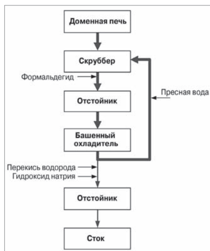
Рисунок 6.20: Пример процесса очистки скрубберной воды от цианида на доменных печах [175]
