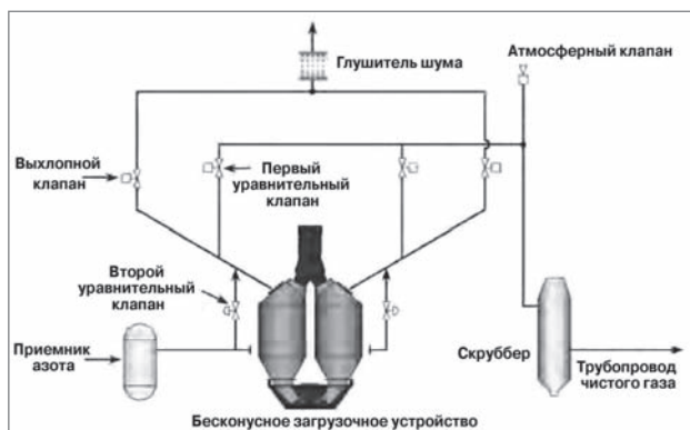
Рисунок 6.18: Схема бесконусного загрузочного устройства с клапанами выравнивания давления, выхлопным клапаном и с системой утилизации газа [90]
