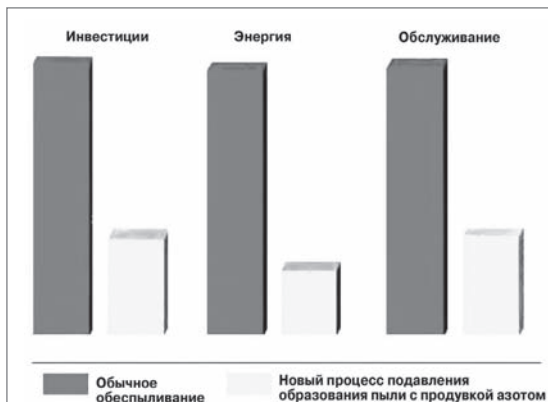
Рисунок 6.17: Сравнение капитальных затрат, затрат на энергию и обслуживание для системы подавления образования дыма на заводе компании ArcelorMittal в г. Бремен, Германия
