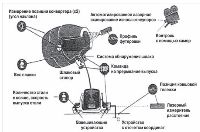
Рисунок 7.25: Схема автоматизированной системы выпуска металла [208]
