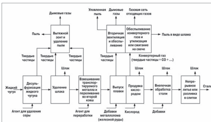
Рисунок 7.2: Последовательность процесса кислородно-конвертерного производства стали с указанием отдельных источников выбросов [200], [365]
