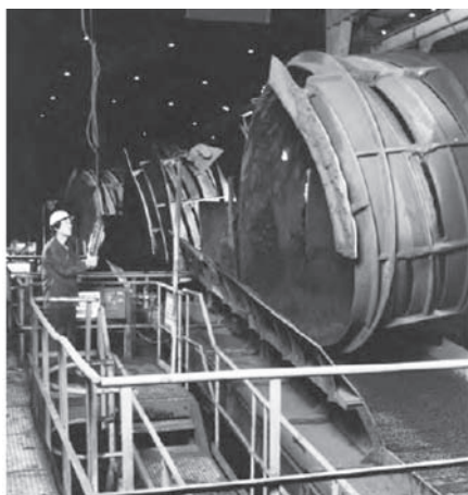
Рисунок 4.1: Барабанный окомкователь как часть установки для получения окатышей, на которой получают сырые окатыши
