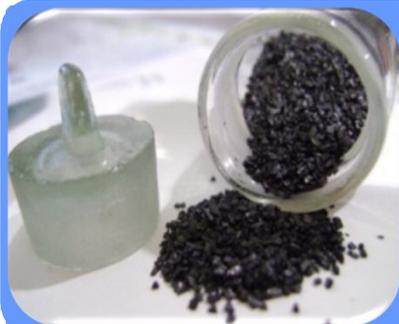
Углеродные молекулярно-ситовые сорбенты – это нанопористые фильтры, задерживающие в себе одни молекулы газов и пропускающие другие.
