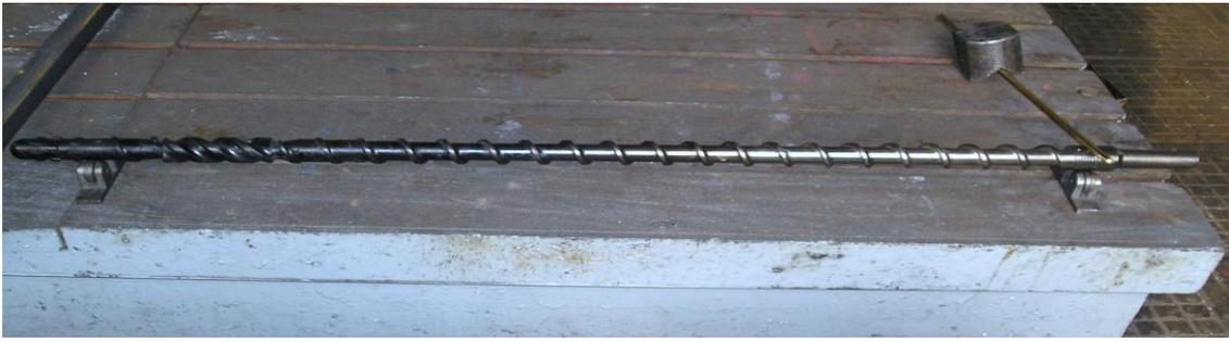
Рис.2 Рабочее место для восстановления шнеков наплавкой.
