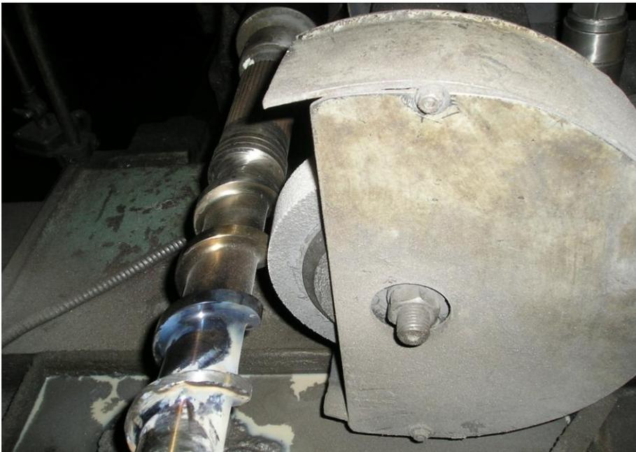
Рис.3 Шлифовальная головка на суппорте токарного станка мод. 1М63.
