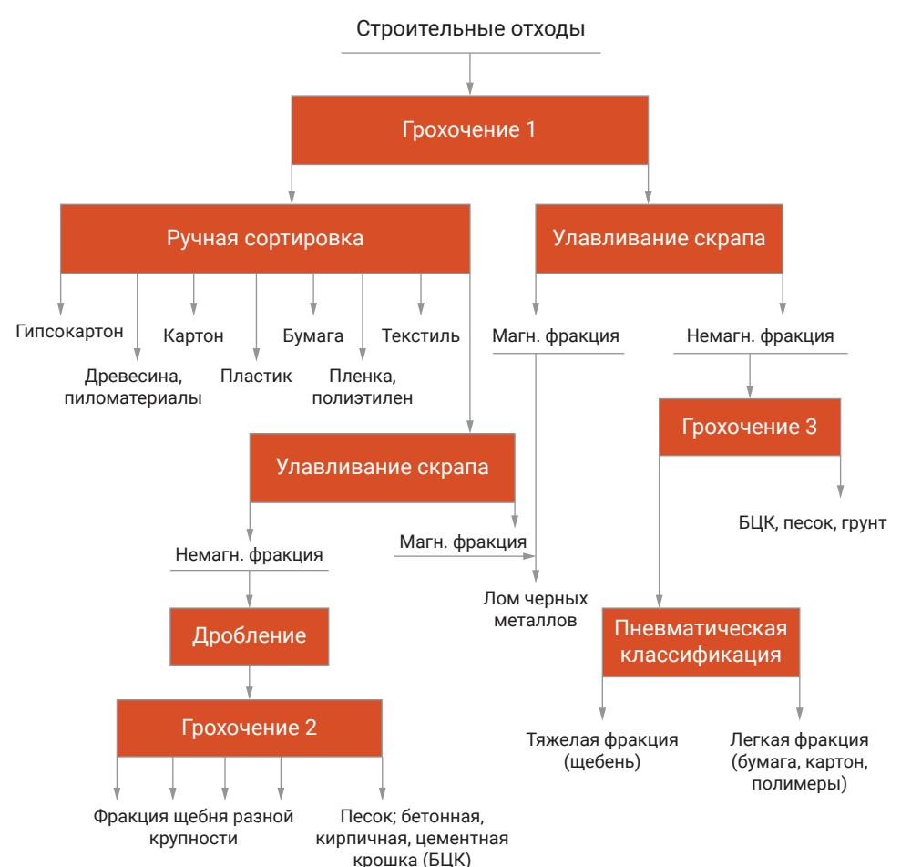
Принципиальная схема сортировки и переработки смешанных строительных отходов
