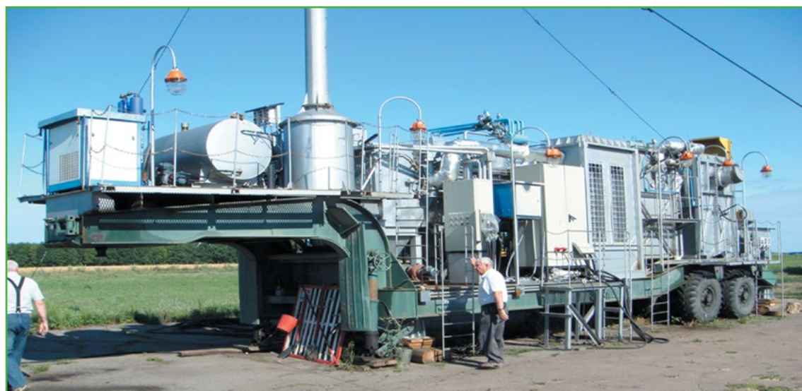
Фото 1. Установка ГП «УкрНТЦ «Энергосталь» для обезвреживания непригодных средств защиты растений в расплаве
