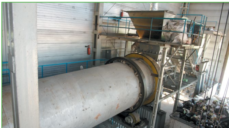
Фото 2. Установка для сжигания ТКО во вращающейся печи в г. Люботине Харьковской обл.
