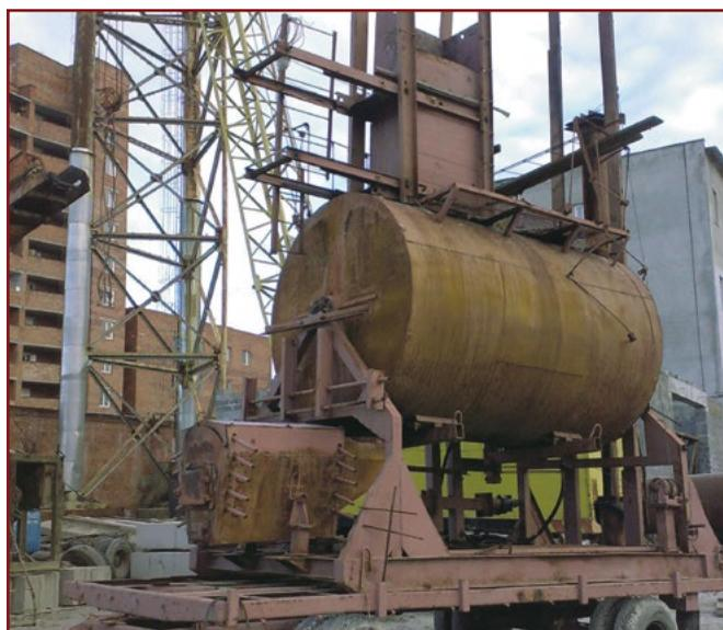
Реактор приготовления катализатора
