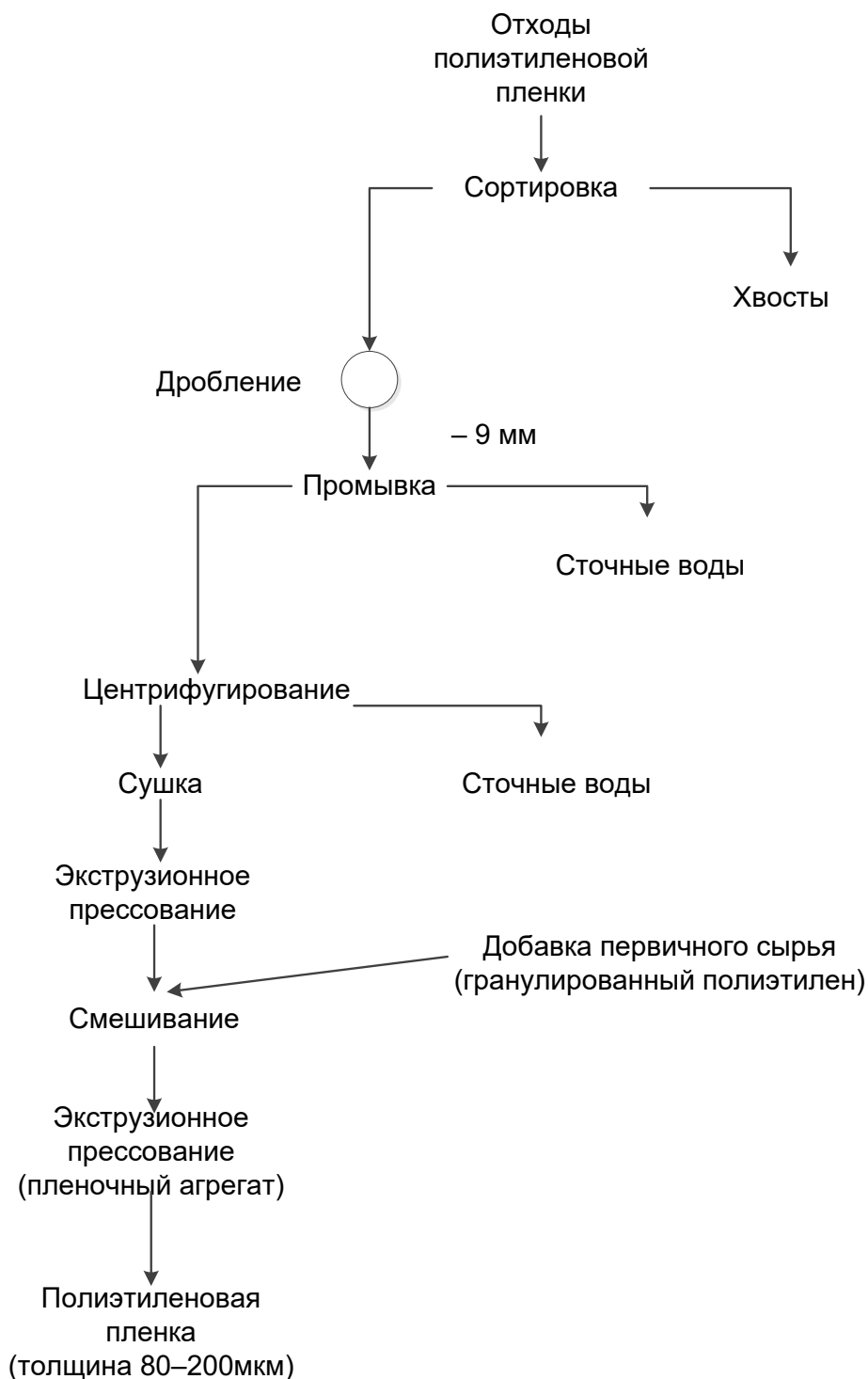
Рисунок 6.7 – Схема переработки отходов полиэтиленовой пленки с применением экструзионного прессования
