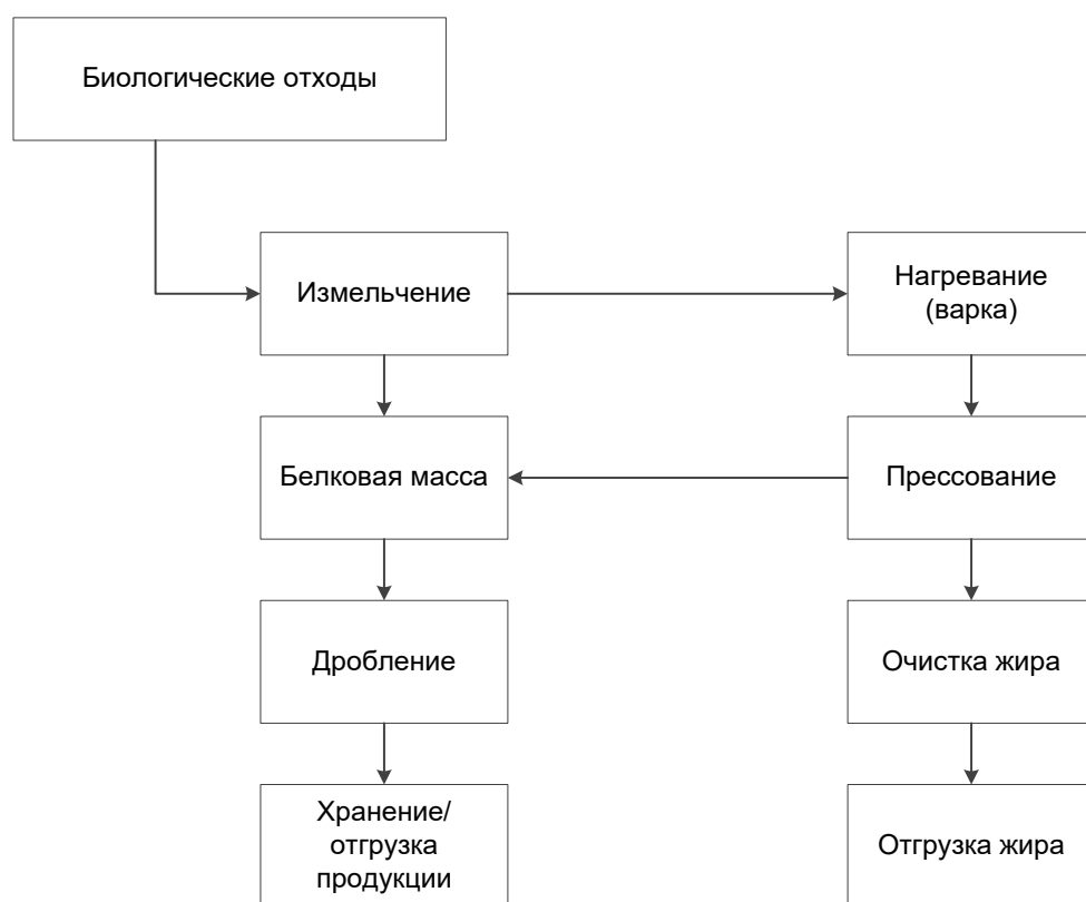
Рисунок 9.1 – Основные стадии технологического процесса утилизации биологических отходов на ветеринарно-санитарных утилизационных заводах и в утилизационных цехах
