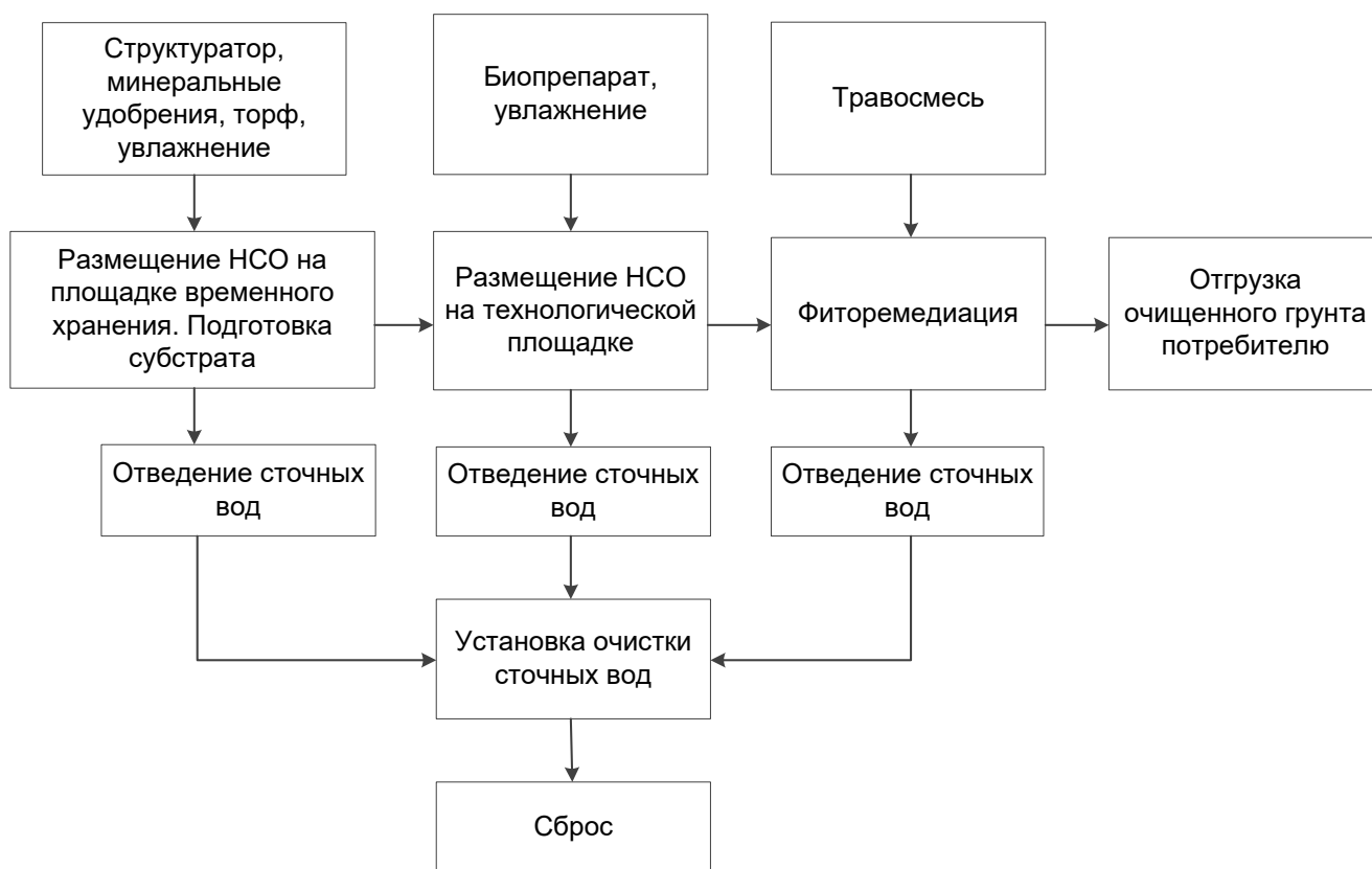
Рисунок 3.4 – Технологическая схема процесса утилизации и обезвреживания нефтесодержащих отходов биологическими методами
