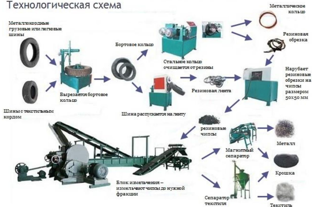
Рисунок 5.3 – Технологическая схема по утилизации изделий из резины, утративших потребительские свойства (шин, покрышек, камер резиновых), в резиновую крошку [48]
