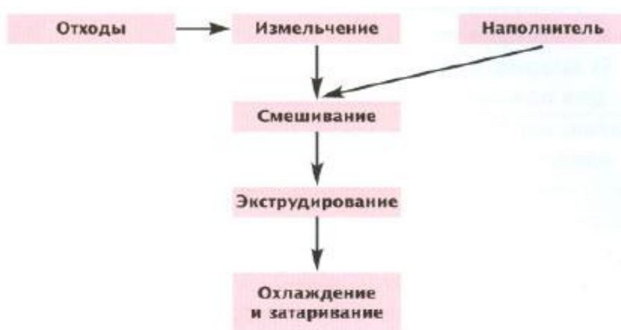
Рисунок 9.3 – Основные стадии технологического процесса экструдирования биологических отходов [99]
