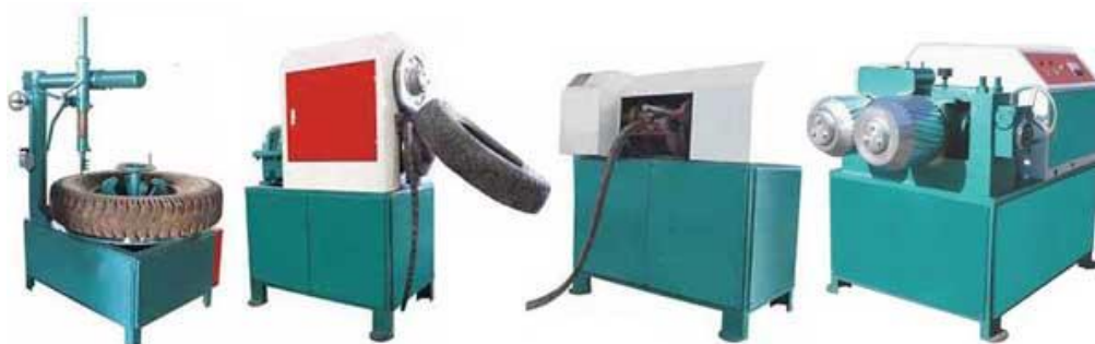
Рисунок 5.2 – Станки утилизации отходов шин, покрышек: вырезатель посадочного кольца, разрезатель на ленту, разрезатель на куски, выжиматель посадочного кольца
