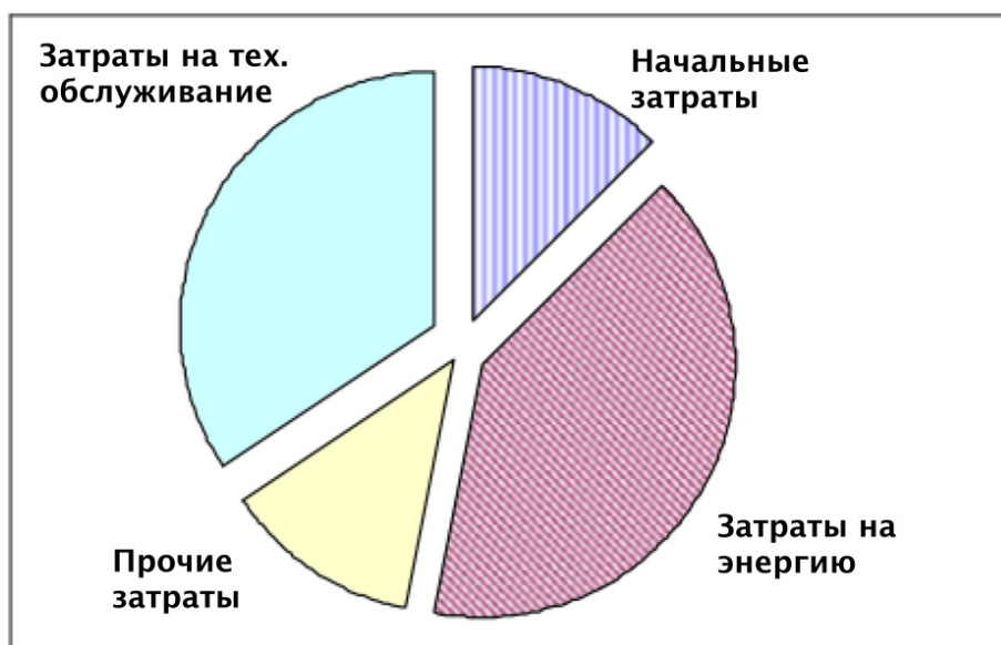
Рисунок 3.39: Типичная структура затрат на протяжении жизненного цикла промышленного насоса средней мощности
