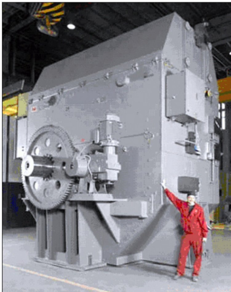
Рисунок 3.26: Привод компрессора с номинальной мощностью 24 МВт
