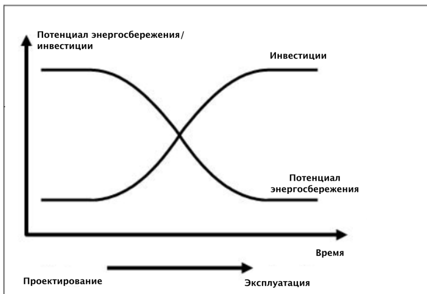
Рисунок 2.4: Потенциал энергосбережения и соответствующий объем инвестиций на этапах проектирования и эксплуатации
