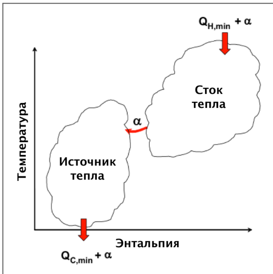
Рисунок 2.15: Передача тепла через пинч от стока к источнику
