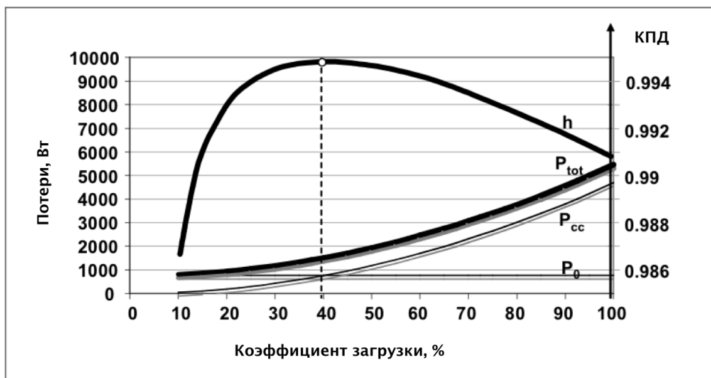
Рисунок 3.24: Уровень потерь и КПД трансформатора в зависимости от коэффициента загрузки
