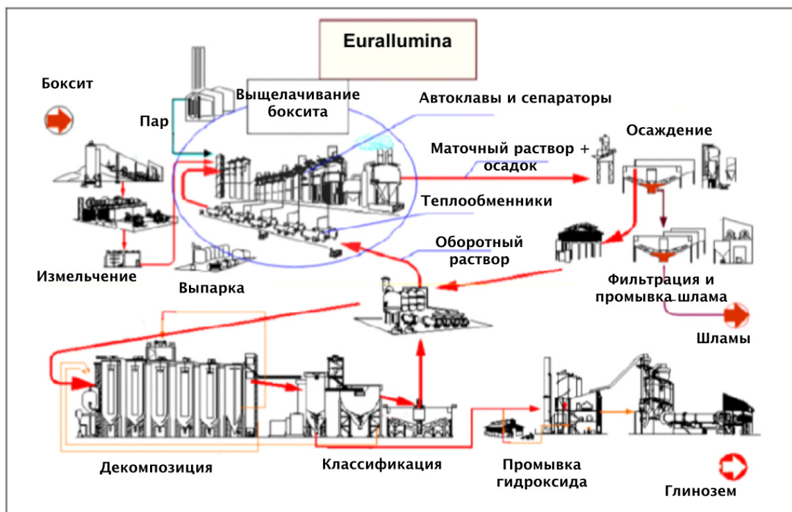
Рисунок 7.14: Схема технологического процесса глиноземного завода Eurallumina [48, Teodosi, 2005]
