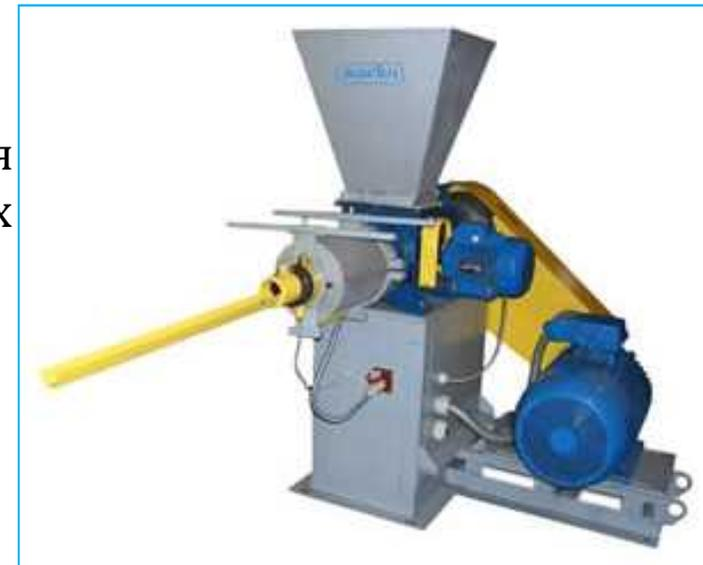
Обеспечивается получение высококачественных экологически чистые топливных брикетов из щепы древесных отходов. Установка реализует технологию баротермической переработки (прессование при высокой температуре)
