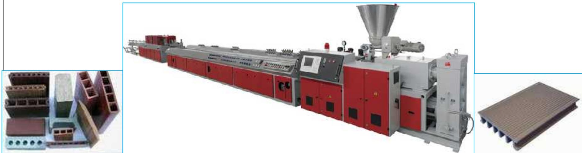
Перерабатывает опилки и древесные отходы в сырье, в различные профили (PE, PP, PVC), которые одновременно обладают характеристиками дерева и пластика.
