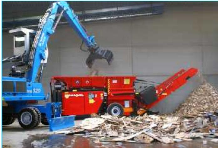
При утилизации древесных отходов используется различное дробильное и сортировочное оборудование, в частности, выпускаемое известной фирмой «HAMMEL Recyclingtechnik GmbH» (Германия). Цель переработки различной древесины – получение технологической щепы для использования в качестве сырья.
