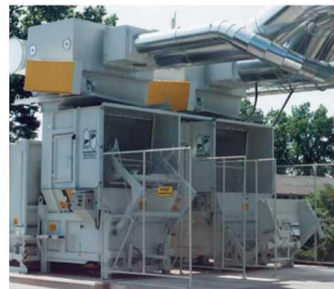
Пресс-контейнер с РМА и опрокидывающим устройством
