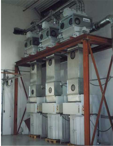
Сепаратор РМА с системой сортировки материала, расположенный над прессами
