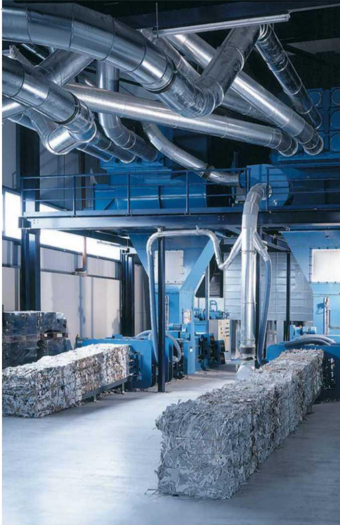
Сепаратор для сортировки материала, выгрузка в два горизонтальных пресса
