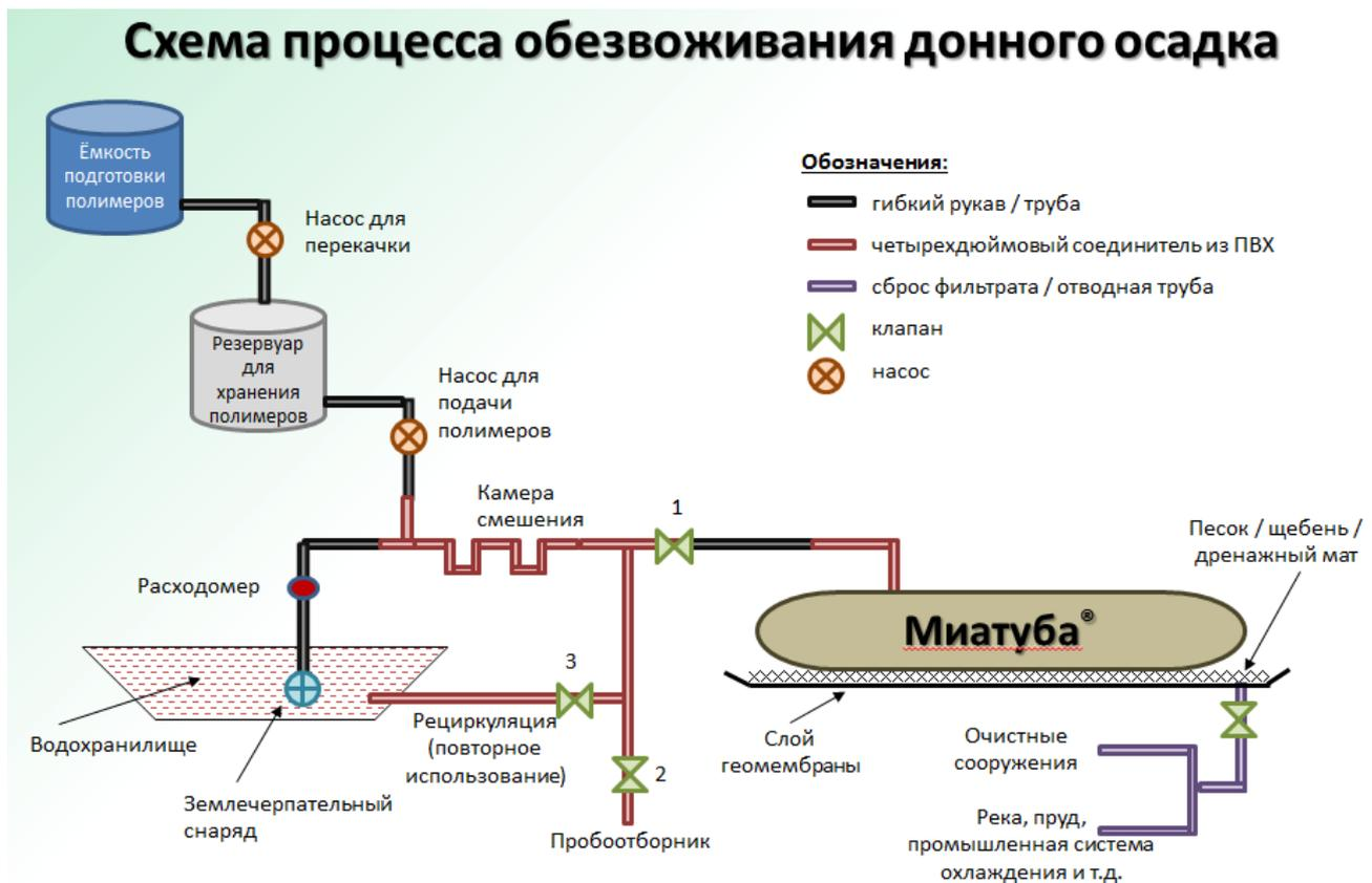
При небольших объемах работ по очистке донных илов допускается закачка осадка без флокулянтов, при определенной потере качества обезвоживания и увеличении сроков технологического процесса.
