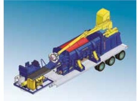
Машина оснащена краном, дизельным двигателем и, опционально, прицепом.
