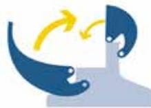
Упрочнённые крышки с двумя цилиндрами каждая (110 и 165 т).
