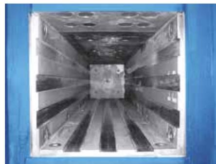
Помимо этого, дизайнерская разработка камеры подпрессовки позволяет осуществлять загрузку одновременно с процессом производства пакета, а также обеспечивает бесперебойную работу машины в автоматическом режиме.
