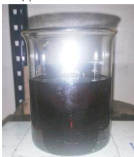
Пиролизная жидкость является отличным энергоресурсом и служит заменой дизельному(темному печному) топливу в жидкотопливных горелках. Также пиролизная жидкость может служить сырьем для получения бензиновой и дизельной фракции. Пиролизная жидкость находит спрос в любом регионе РФ по цене от 12 до 20 руб./литр.
