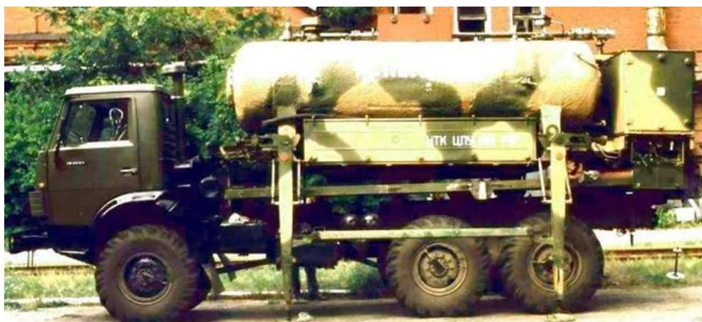
Мобильный комплекс производит очистку и обеззараживание воды от естественных и принудительных загрязнений (техногенные катастрофы и терроризм). В их числе отравляющие вещества, гербициды и дефолианты, растворенные нефтепродукты, спорные формы патогенных бактерий и вирусов и т.п. Комплекс позволяет хранить, транспортировать, кондиционировать и периодически очищать хранимые запасы воды на уровне требований СанПиН 2.1.4.1074-01.
