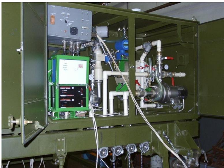
Мобильный комплекс термостатирован и имеет в своём составе электронасосные агрегаты, фильтры, систему фотохимического окисления, датчики уровня, систему контроля функционирования и управления и автономную систему электроснабжения.
